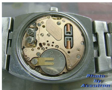
ภาพที่ 1-8 การใส่ถ่านนาฬิกาต้องถูกขั้ว ที่มา : www.siamnaliga.com/forum/index.php
